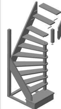
8. В паз столба заводят шип верхней струны (поз. 20) и крепят её саморезами 3,5x70 мм.
