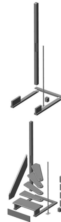
1. Сборку лестницы начинают соединив основание из трех нижних связок (поз. 1, 2 и 3). Связки располагают под прямым углом. Между собой их скрепляют саморезами 3,5x35 мм.
