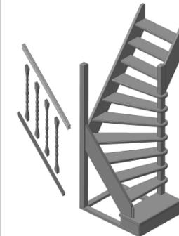
11. Собранный конструкцию крепят на торец струны, между столбами. Все скрепляется саморезами 3,5x70 мм.
